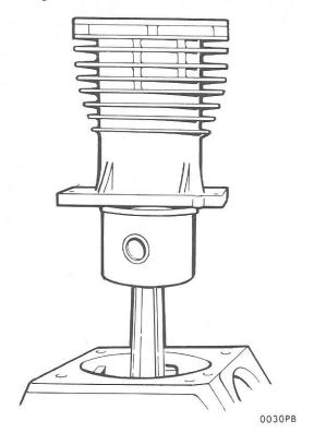
Figure 19-Installing Cylinder
